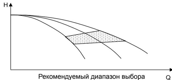
Ещё один фактор, который следует принимать во внимание при выборе насоса – это значение NPSH. Нельзя выбирать насос, рабочая точка которого сильно смещена вправо на характеристике NPSH. В этом случае, особенно если насосы установлены выше уровня перекачиваемой воды, возникает риск нарушения нормального всасывания.
