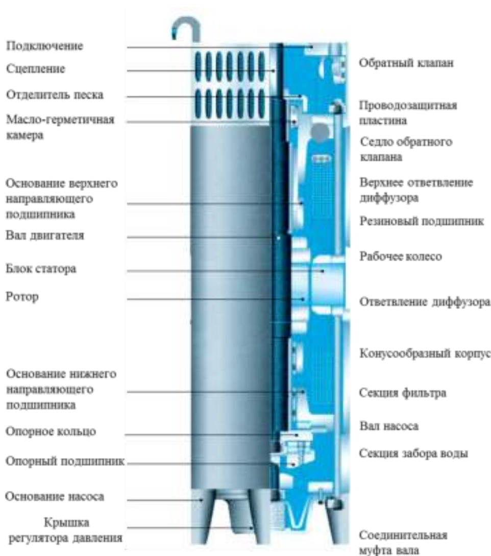
Рисунок 12. Структура двигателя погружного агрегата насосного SM
